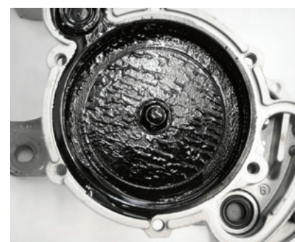
Рис. 3. Масляный шлам в вакуумном насосе VW Transporter, приводящий к появлению стука
